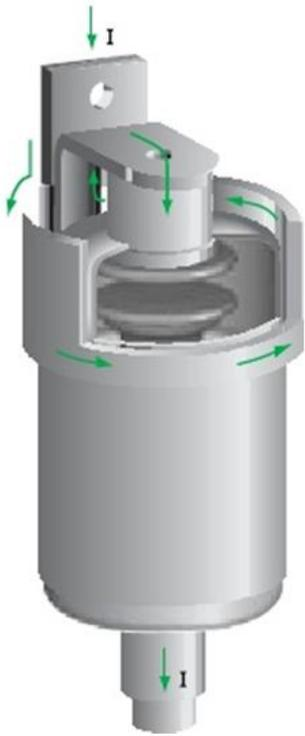
Bobina exterior a la cámara de vacío
